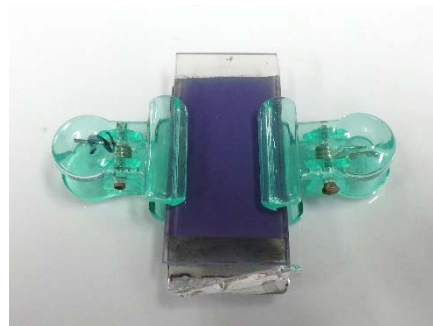
ブルーベリーパワーの電池
